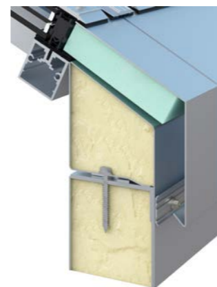
Montage auf Stahlblechzarge
